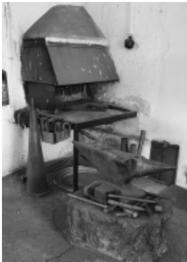
Bereits morgens mußte das Schmiedefeuer angeheizt werden. Mittels Luftzufuhr wird die Glut (Esse) auf die richtige Temperatur gebracht.
