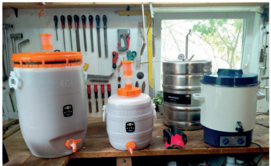
Gärfässer, Druckmostfass und Druckmostentsafter
